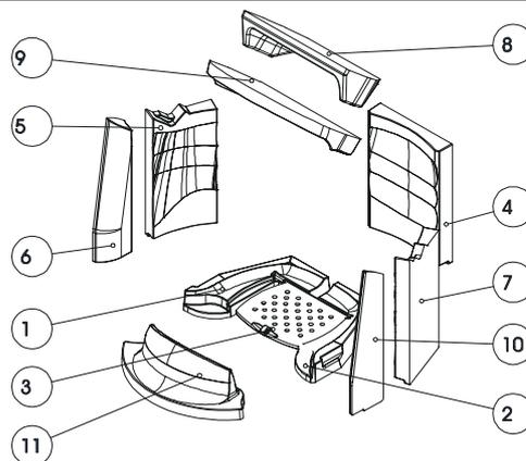
Numerazione dei refrattari = ordine da seguire per il montaggio!
