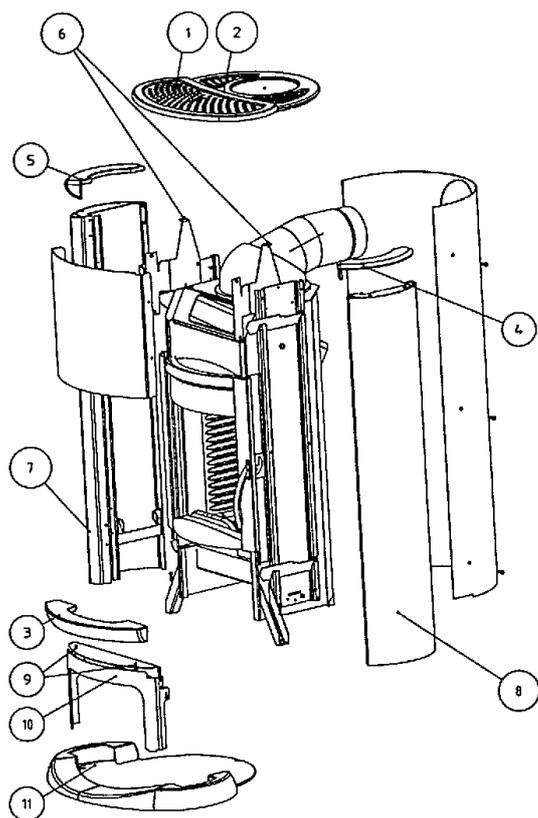
Fig. 6: Elementi del rivestimento
